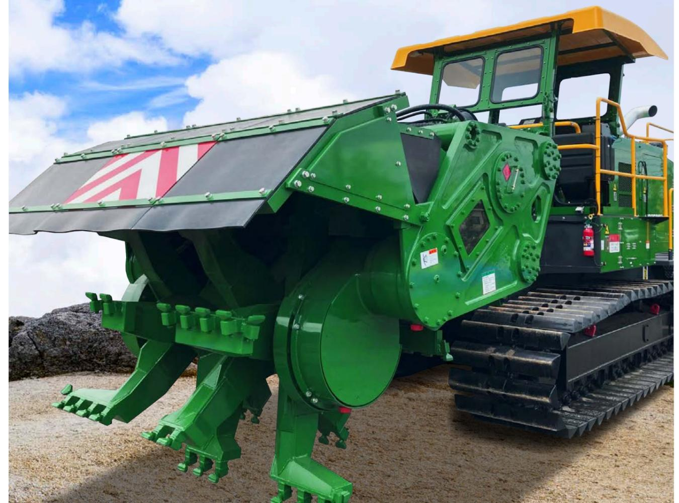
混合深さ自動制御システム搭載
