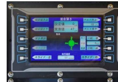
運転席のフルカラーディスプレイには、混合深さ自動制御システムの設定・表示のほか、速度表示や各種表示、各種作業設定が行えます。
