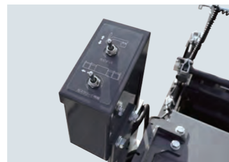
▲スクリード最側部スイッチBOX取付
