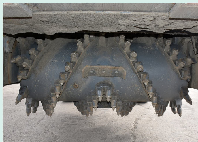
モールドボード（ドラムカバー）はフルオープンするので点検や整備がしやすくなっています
