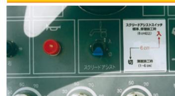
路盤材施工などの厚層舗装時、また軟弱路盤などで使用します。
