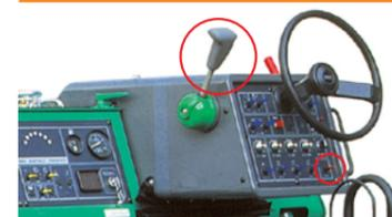
走行レバー及び自動・手動切換スイッチ/作業・走行スイッチ停止がONの時は、エンジンは始動しないシステムになっています。
