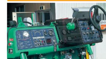
使用頻度の高いスイッチ類を運転席操作パネルに集中配備。また、前後進は走行レバー1本で任意な速度が得られ、安全かつ効率的に舗装作業が行えます。
