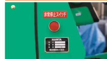
本機は、エンジンを緊急停止する非常停止スイッチを本体左右2ヶ所に設け、安全性を向上しています。
