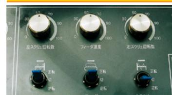
合材自動供給システム使用中も単独制御可能となりました。フィーダとスクリュのスピードコントロールは電磁比例(可変)式とし、作業に最適な搬送量と横送り量が得られます。またスクリュは左右単独・正逆回転操作も可能です。
