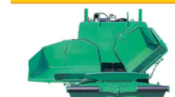
ホッパは2段折畳式で、油圧シリンダによる左右単独操作が可能。舗装現場に合わせて調整ができ、また障害物も避けられ大変便利です。
