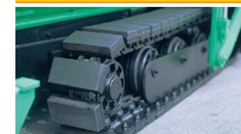
クローラは耐久性のある好評のゴムパッド付で、クラストップの牽引力で舗装路面も安心して走行でき、クローラ張調整は、グリースアップ式で容易に調整できます。
